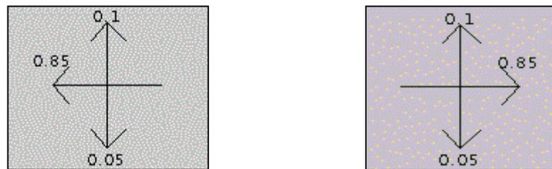
**Figure 3.13** – Fonction de transition pour les actions pivoter gauche et pivoter droite
